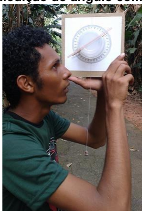
Figura 2 - Medição do ângulo com o teodolito
